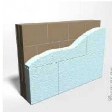
2. Izolacja ze styropianu EPS na zaprawie klejowej
