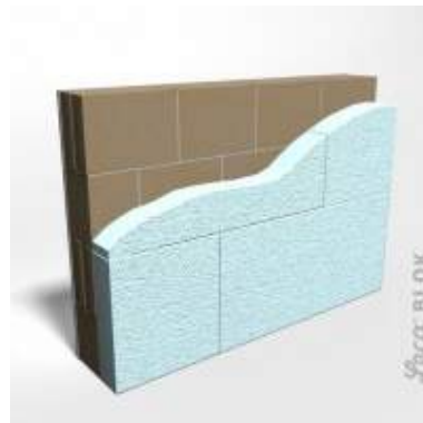
2. Izolacja ze styropianu EPS na zaprawie klejowej
