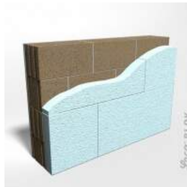
2. Izolacja ze styropianu EPS na zaprawie klejowej
