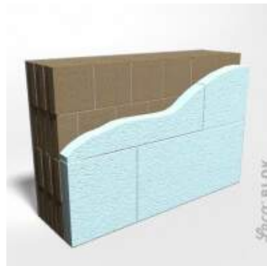
2. Izolacja ze styropianu EPS na zaprawie klejowej
