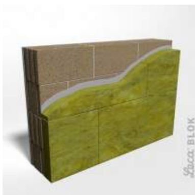
3. Izolacja z wełny mineralnej na zaprawie klejowej
